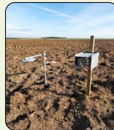
Installation pour la mesure de volatilisation de l'azote
